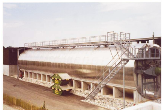
Digesteur de biodéchets
